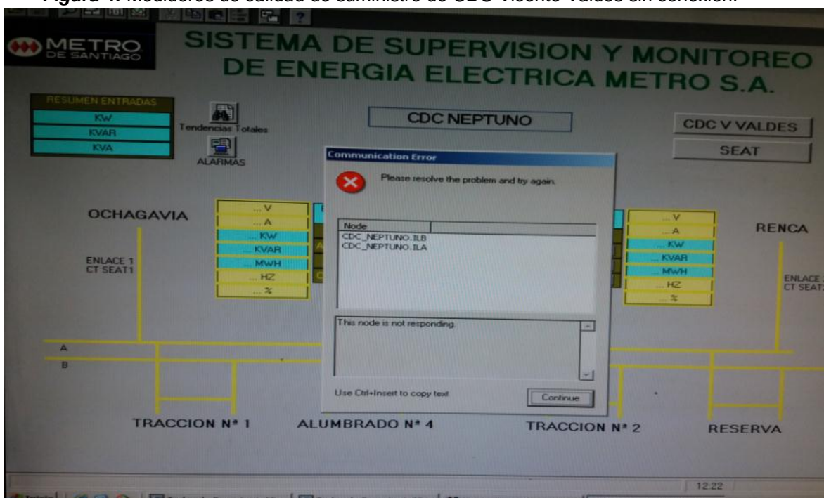
Figura 5: Medidores de calidad de suministro de CDC Neptuno sin conexión.
