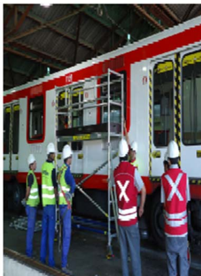
F – N°2: Muestra la instalación del Andamio, ubicación frente al carro para realizar el brandeado.
