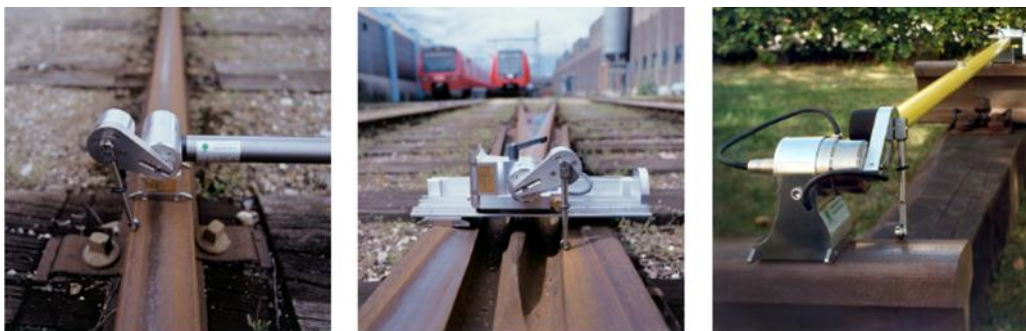
Fig 5 Equipo Miniprof Inspeccionando Riel
