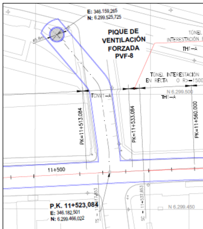
Figura N°8: Planta Emplazamiento Pique Ventilación Forzada Morande
